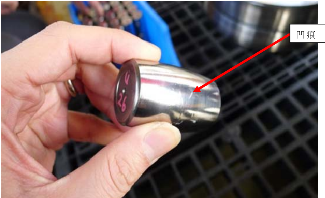
圖 7：上軸承的頂部滾柱的凹痕
