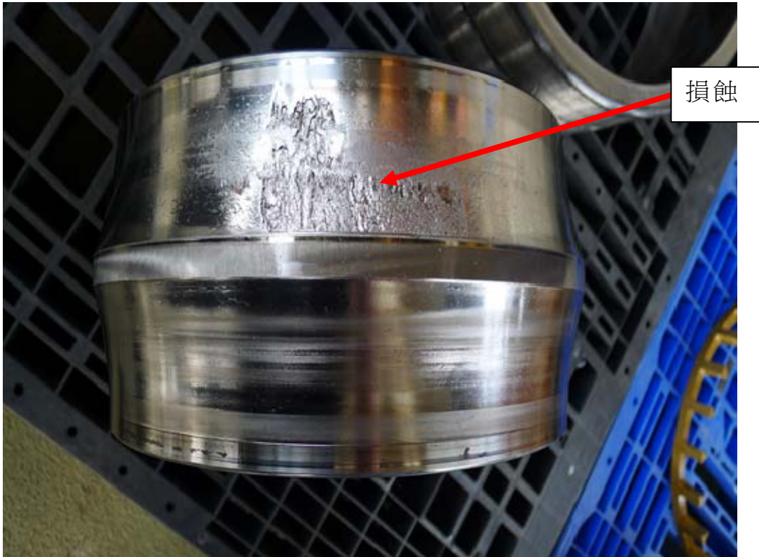
圖 5：上軸承內環的頂端滾道之損蝕
