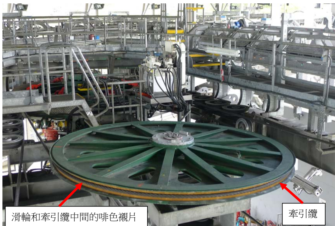
圖 4：牽引纜圍繞在 4 號滑輪襯片上
