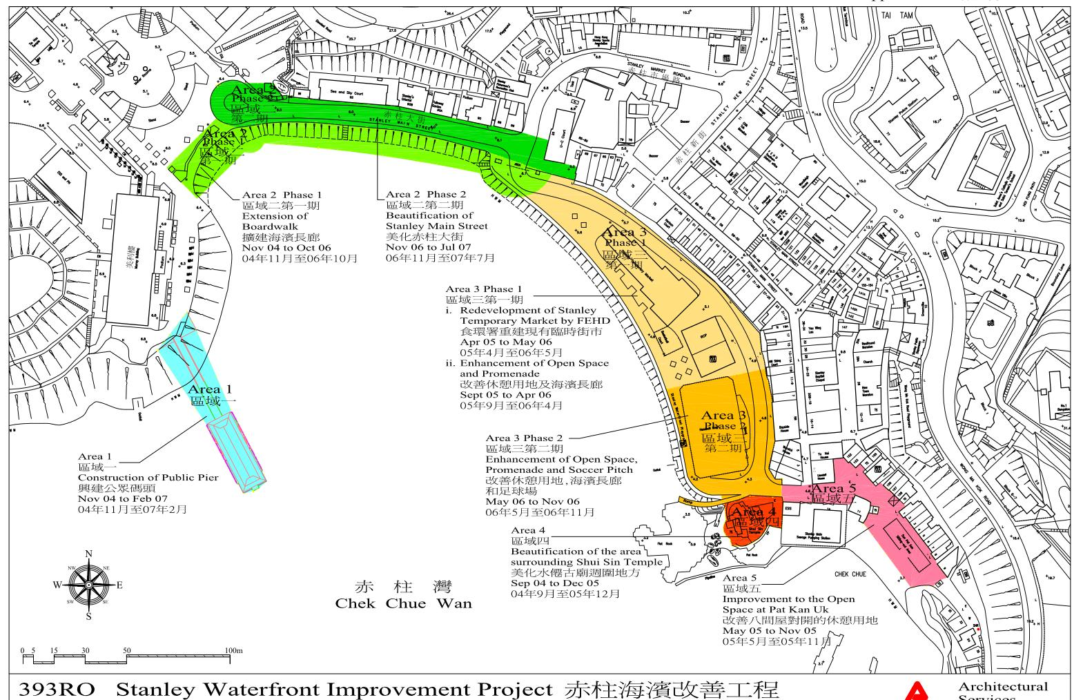
Construction Phasing Plan 施工階段設計圖
